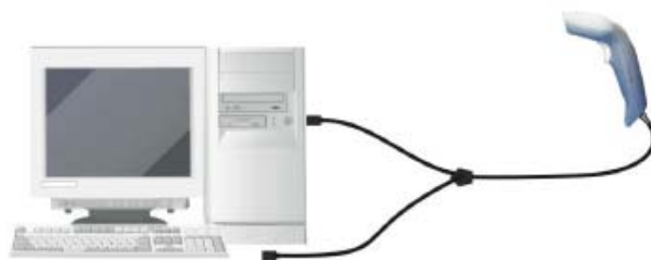
Slika 1: Priključenje čitača na osobni računar
