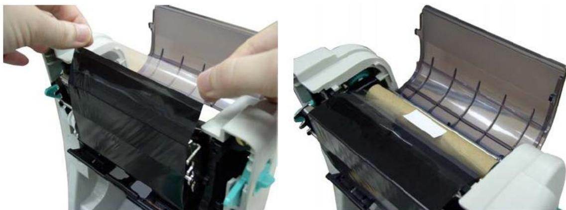
6. Nazubljenim zatezačem prazni deo ribon trake navijemo na praznu čauru.
